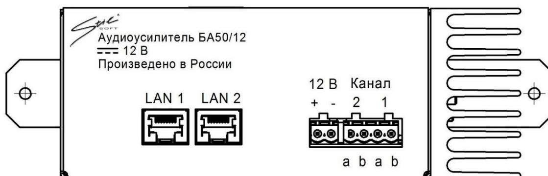
12В – Разъем для подключения входного напряжения постоянного тока 12В
