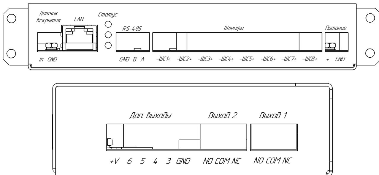
Датчик вскрытия – Разъем для подключения внешнего датчика вскрытия
