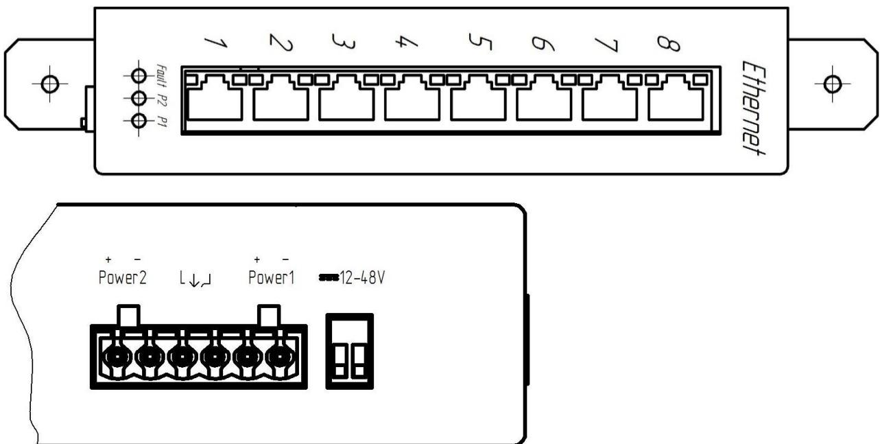
1–8 – Разъемы RJ-45 для подключения сетевых устройств на скорости 10/100 Мбит/с
