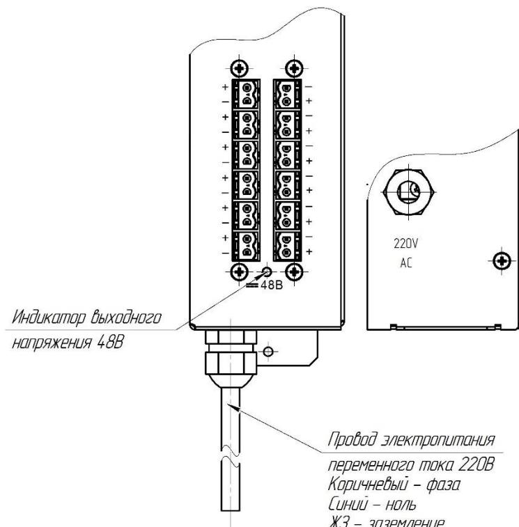
«+» и «-» – Разъемы подключения преобразованного напряжения постоянного тока 48 В
