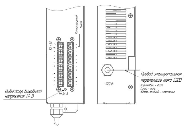
XP1...XP12 — Разъемы подключения преобразованного напряжения постоянного тока 24В Коммутируемый выход — Разъем подключения преобразованного коммутируемого напряжения постоянного тока 24В А, В — Разъем интерфейса RS-485
