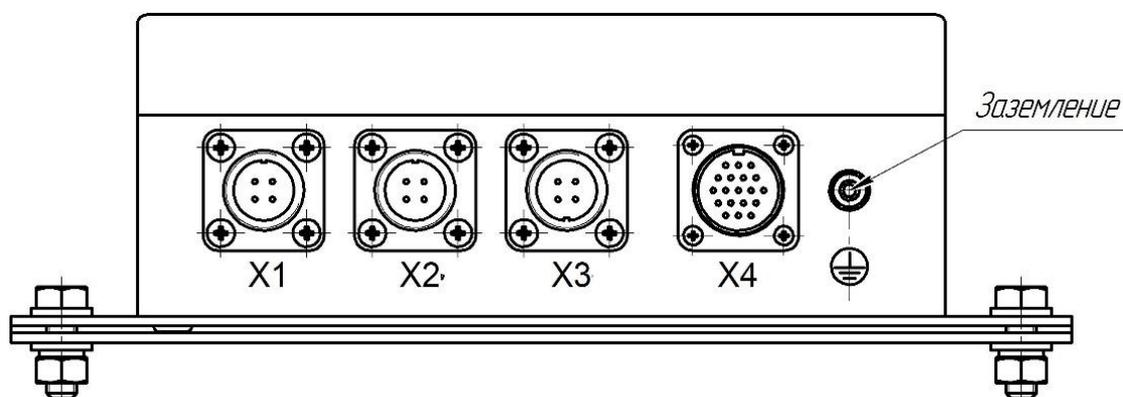
X1 – разъем для подключения вибрационно-сейсмического чувствительного элемента
