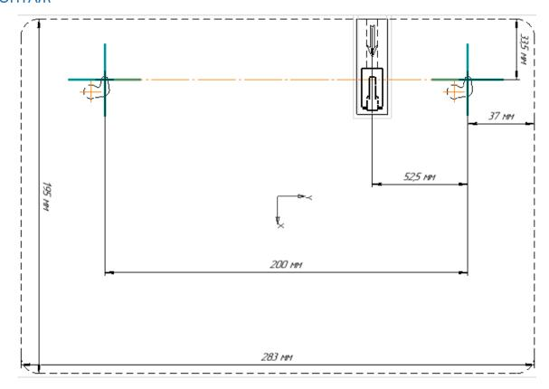
Диаметр крепежных отверстий зависит от типа поверхности крепления изделия (гипсокартонная или бетонная). В составе КМЧ предусмотрены пластмассовый распорный дюбель 5х30 под бетонную поверхность и дюбель пластиковый для ГПК Driva 12х32 под гипсокартонную.
