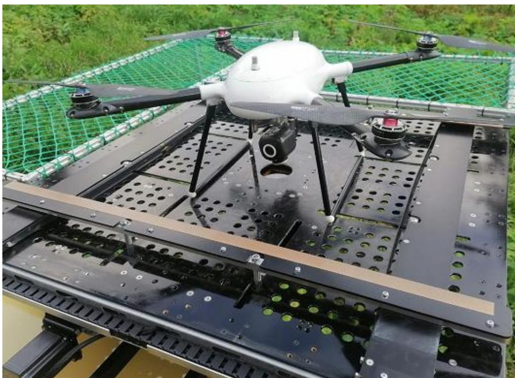
Рисунок 11. БВС на выдвижной платформе СК
