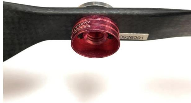
Рисунок 9. Быстросъемный адаптер пропеллера
