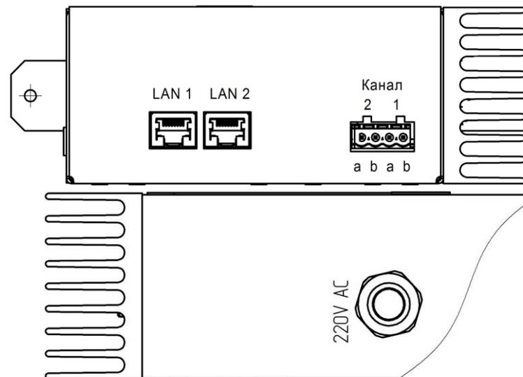
LAN1, LAN2 – Разъемы для подключения к сети Ethernet;
