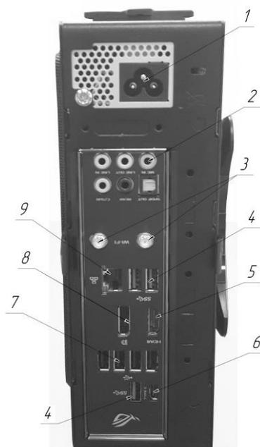
Рисунок 1 – Подключение контроллера видеостены (расположение и внешний вид разъемов может отличаться от приведенного)
