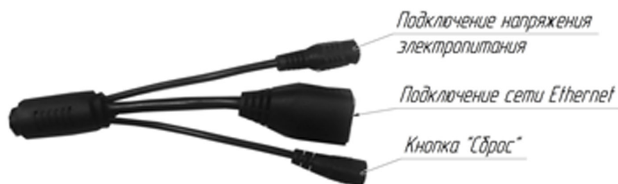
Рисунок 3 – Назначение разъемов кабеля подключения изделия
